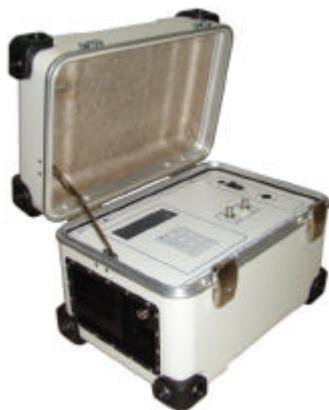
*Le simulateur de couverture radio WiMAX est une unité portable destinée aux applications d'ingénierie cellulaire dans le cadre de l'évaluation des couvertures des stations de base. Cet équipement possède 2 modes de fonctionnement, l'un en mode CW (émission d'une porteuse pure), l'autre en mode spectral (accès à la bande de base I&Q). L'utilisation en application extérieure a été particulièrement étudiée afin de préserver la stabilité de la puissance de sortie sous toutes conditions.*
